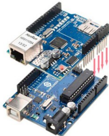
Conectando Arduino a Internet con el escudo Ethernet.
