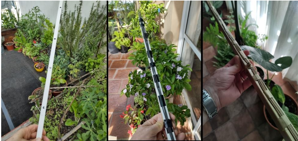
Sistema de sensores ensamblado con un cable canal.
