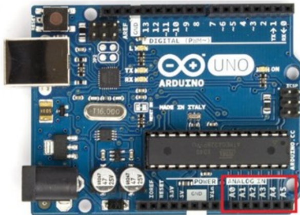
Pines analógicos en la placa Arduino Uno.
